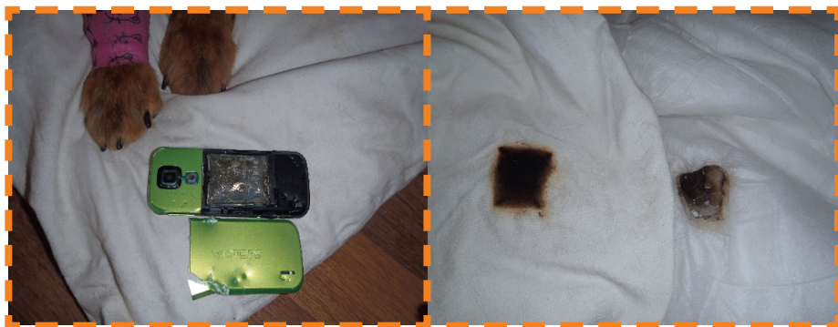
Baterie mobilního telefonu rozkousaná psem a následně prohoření pelechu po rozkousání (včas uhašeno majiteli psa, dříve než se požár rozvinul)
