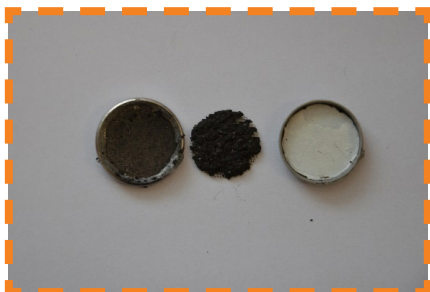
Exploze knoflíkové baterie v důsledku zvýšené teploty (asi 130 °C)
