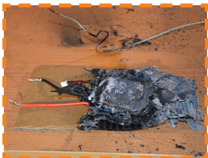
Požár akumulátoru při nesprávném nabíjení
