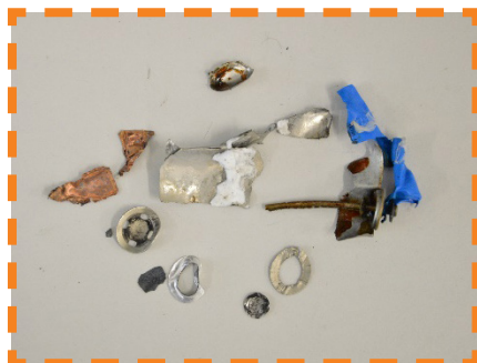
Exploze baterie při nabíjení (nenabíjecí baterie)
